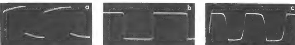
Bild 10. Durchlaß von Rechteckimpulsen über den Hauptverstärker bei folgenden Impulsfolgefrequenzen; a) 40 Hz, b) 1000 Hz, c) 10 000 Hz
