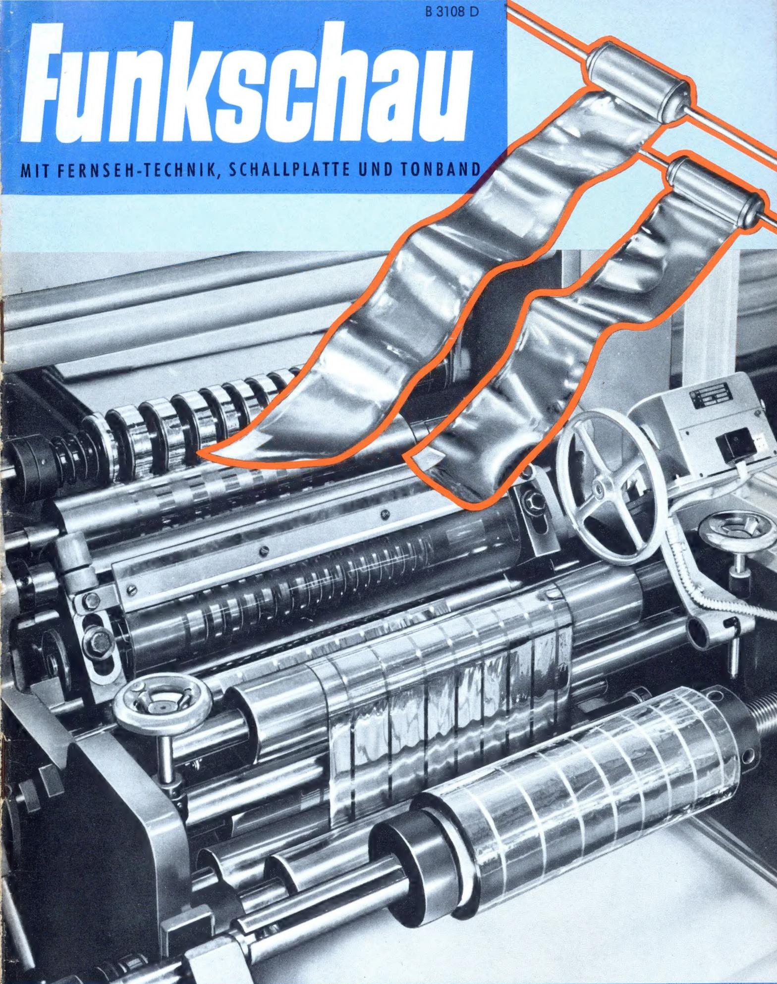
Diese Maschine schneidet aus einer breiten Bahn schmale Streifen von metallisierter Polyesterfolie zum Herstellen von Kondensatoren-Wickeln (Wilhelm Westermann, Mannheim)
