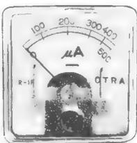
**Preiswerte Einbau-Meßinstrumente**, Drehspulwerk, moderne quadratische Form, glasklare Plastikabdeckung, Messerzeiger, Nullpunkt-korrektur. Spannungsabfall bei Strommessern 50 mV, Innenwiderstand bei Spannungsmessern: 1000 Ohm/V. Nur für Gleichstrom.
